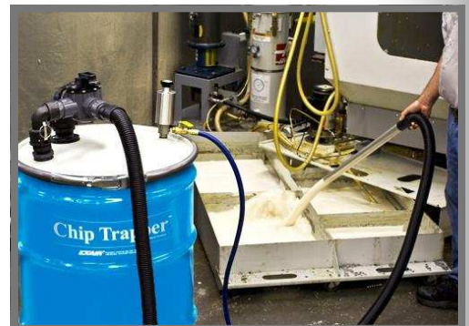
Chip Trapperen pumper kjølevæsken tilbake i sumpen fri for spon og andre forurensninger
