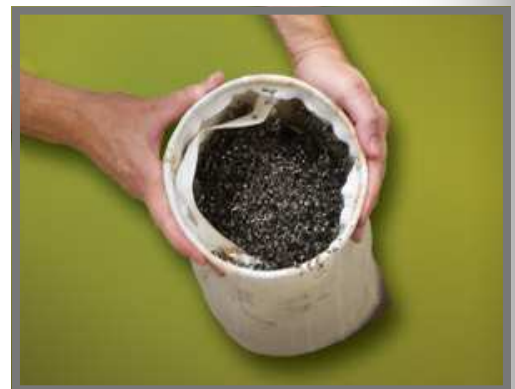
Filterposen på 5 micron samler opp all spon slik at kun ren kjølevæske pumpes ut av fatet.
