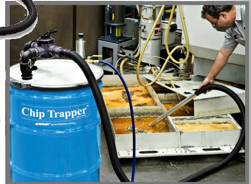
Spon akkumuleres i sumpen og sirkulasjonen av kjølevæsken blir redusert
