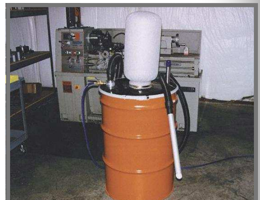
Spon kan støvsuges direkte til separate fat for å skille innholdet dersom det skal resirkuleres
